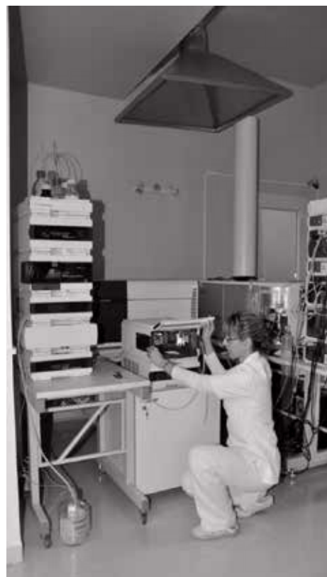
Agilent 6460 Triple Quadrupole (QQQ) je hmotnostný spektrometer s hmotnostným analyzátorom typu trojitý kvadrupól schopný merať hmoty v rozsahu 5 – 3 000 amu
